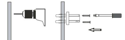
**INSTALLING ONTO A SOLID SURFACE**
