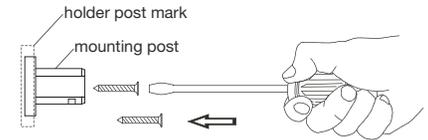
**INSTALLING ONTO DRYWALL SURFACE**
