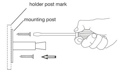
**INSTALLING ONTO DRYWALL SURFACE**
