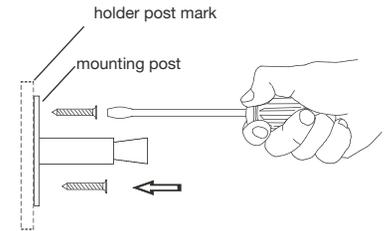
**INSTALLING ONTO DRYWALL SURFACE**
